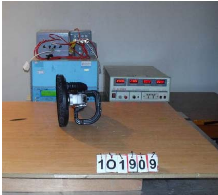
Figure 7 EFT test setup
