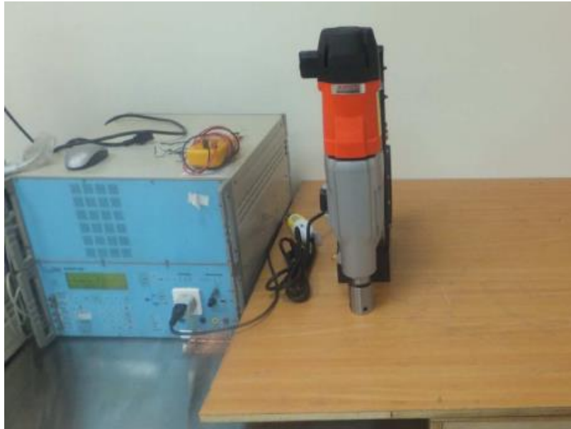
Figure 7 EFT test setup
