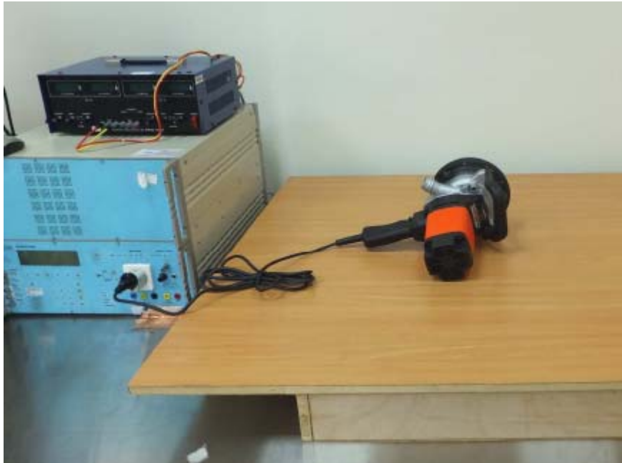
Figure 6 EFT test setup
