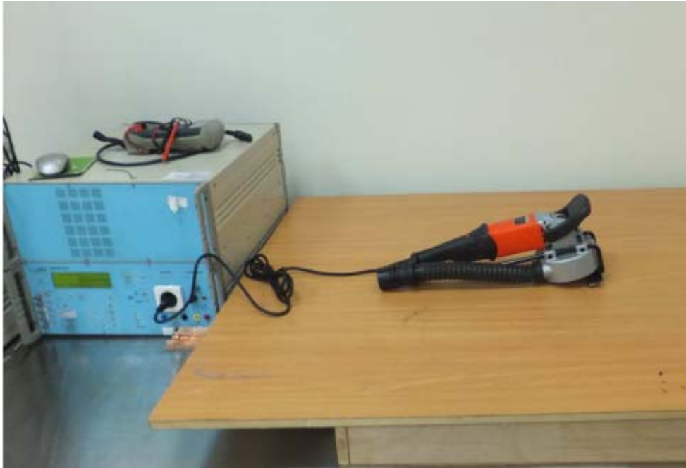
Figure 8 EFT test setup
