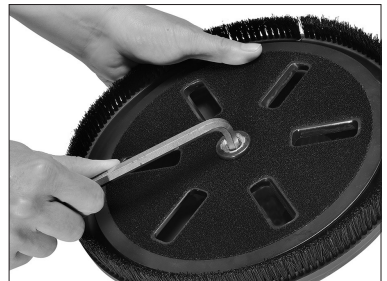
Løsning af slibpladen
