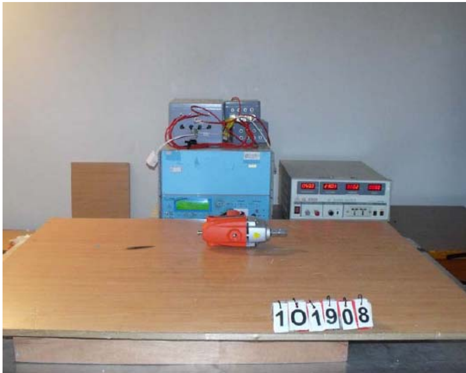
Figure 6 EFT test setup
