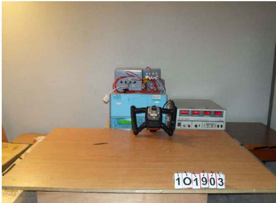
Figure 8 EFT test setup
